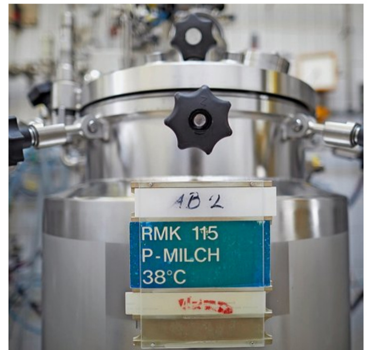
Les cultures sont produites à base d'eau et de lait en poudre dans des fermenteurs en acier inoxydable.
